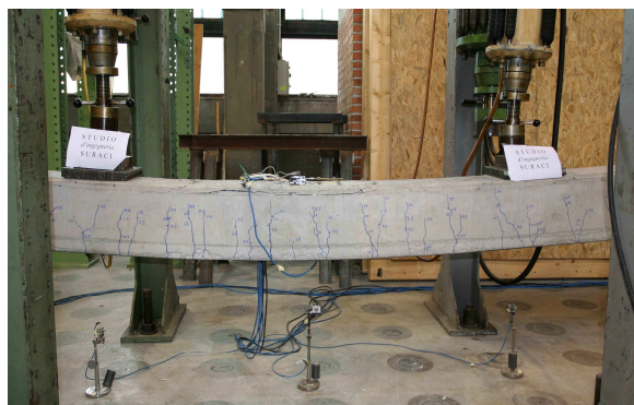
Fig. 11 Trave con soletta piena al collasso.
